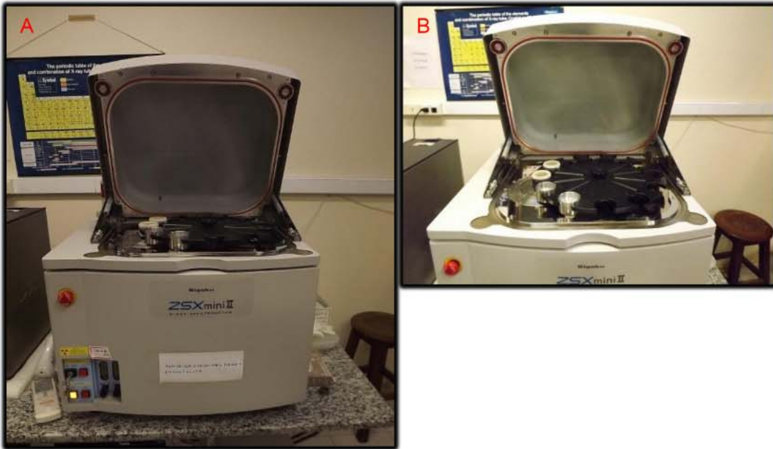
Figura 4.6 – Equipamento de Fluorescência de raios X; A - Equipamento vista externa, B - vista Interna.
