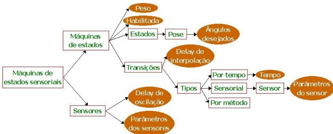
Figura 4.5: Tipos de parâmetros vinculados à estrutura da representação “máquinas de estados sensoriais”.
