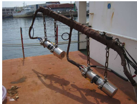
Figura 1.5: Duas airguns usadas no processo de captura sísmica nos oceanos.
