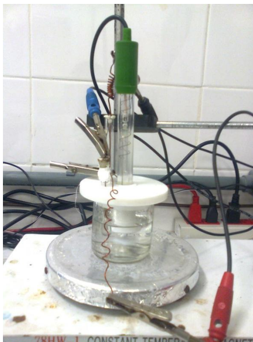
Figura 1: Fotografia do sistema de pH interfacial. Em destaque, o eletrodo de pH está acoplado à tela de platina (eletrodo de trabalho).
