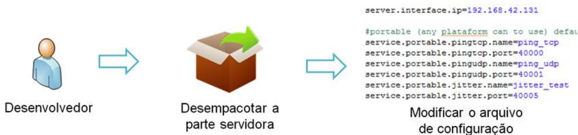
Figura 3.3. Passos da configuração servidor do MpOS
