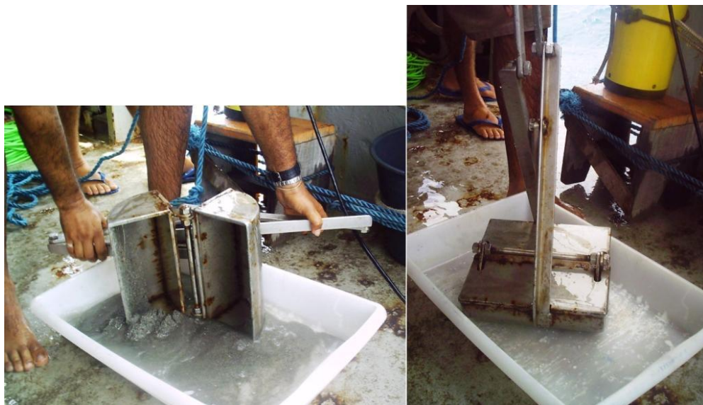
Figura 25 – Coletor de amostras de sedimento tipo Van Venn.
