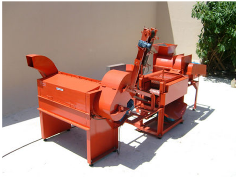
Figura 4: Equipamento para beneficiamento da casca do coco verde desenvolvido pela EMBRAPA em conjunto com a FORTALMAG.
