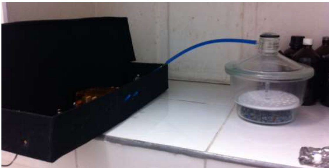
Figura 3 – Dessecador contendo o frasco rosqueado aberto contendo uma mistura dos 10 padrões externos na concentração de 100 \mu\text{g}/\text{m}^3 , acoplado via mangueira ao cartucho e a bomba de amostragem de ar.
