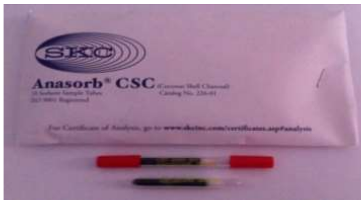
Figura 2 – Cartuchos de 70 mm de comprimento e 6 mm de diâmetro (Marca 226-01 SKC-ANASORB CSC).
