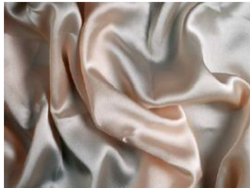
Figura 3.2: Flambagem de um tecido real [Choi e Ko, 2002].
