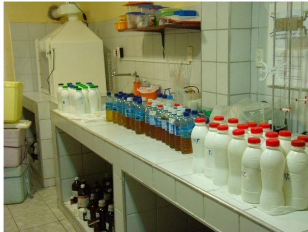
Figura 8 – Amostras recém-chegadas ao laboratório divididas por estrato (sub-superfície e fundo) e as amostras fixadas in situ para à análise de oxigênio dissolvido.
