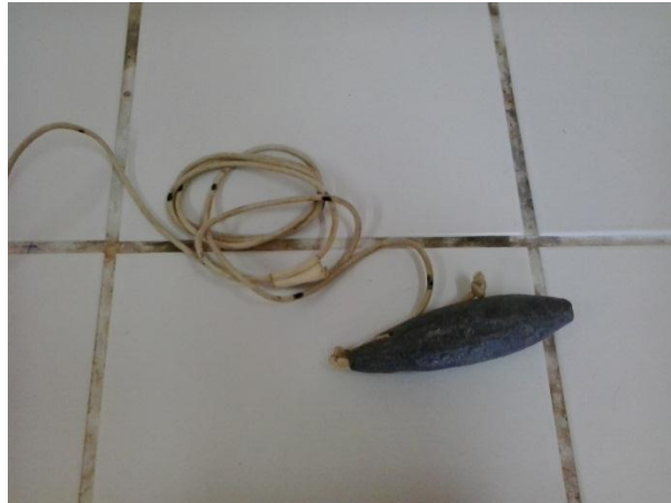
Figura 4 – Prumo de mão utilizado para medir a profundidade dos pontos C e TR
