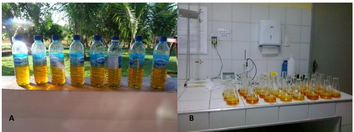
Figura 5 – A: Frascos logo após a fixação do oxigênio in situ ; B: Erlenmeyers com amostras separadas para a análise de oxigênio dissolvido.
