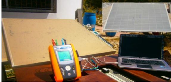
Figura 13 – Uso de um traçador de curva IxV comercial para estudos de sujidade
