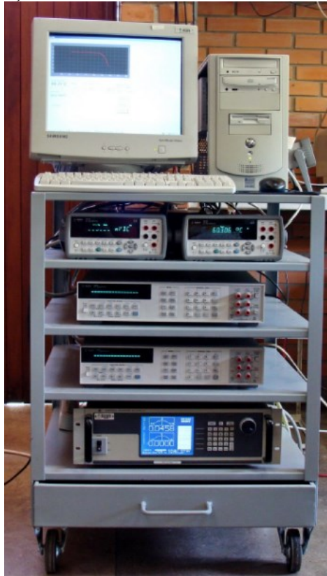
Figura 22 – Traçador de curva IxV construído com fonte de 4 quadrantes
