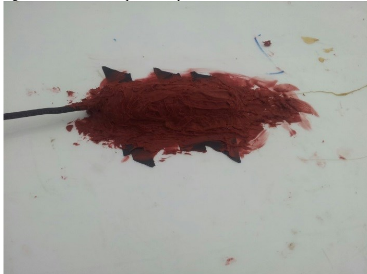
Figura 53 – Sensor e espuma acoplados ao módulo através do silicone
