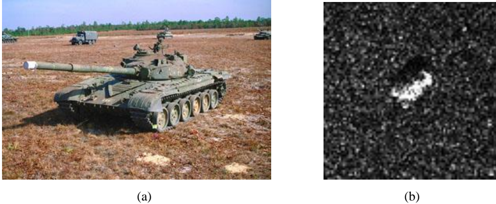
Figura 50 – (a) Foto de um veículo T-72 e (b) imagem de um veículo T-72 gerada por um dispositivo SAR.
