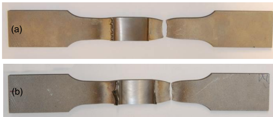
Figura 106 - Corpos de prova após o ensaio de tração uniaxial (a) Condição 3 (b) Condição 4.
