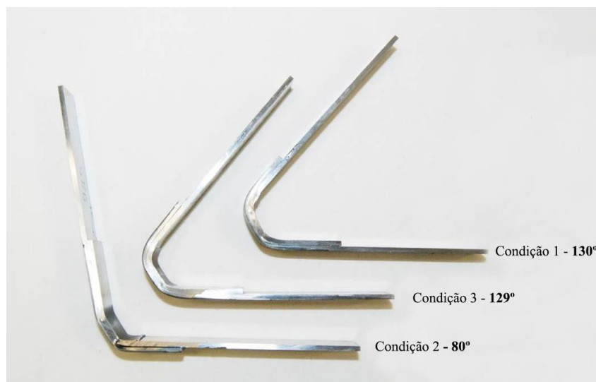
Figura 119 - Amostras de dobramento depois do ensaio, amostras AISI 444.
