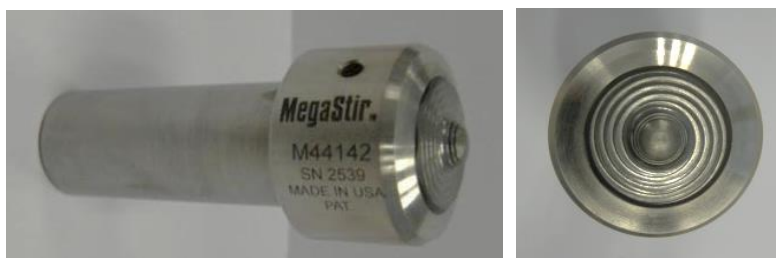
Figura 23 - Ferramenta a base de PCBN utilizada no trabalho.
