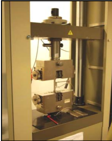
Figura 28 - Equipamento Zwick/Roell e geometria do corpo de prova para ensaio de tração.
