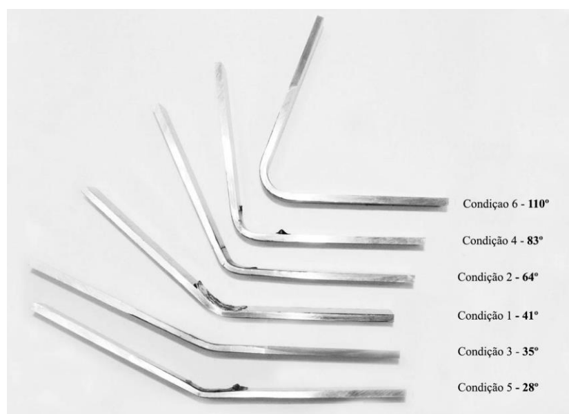
Figura 56 - Amostras do material AISI 304L submetidas ao ensaio de dobramento.
