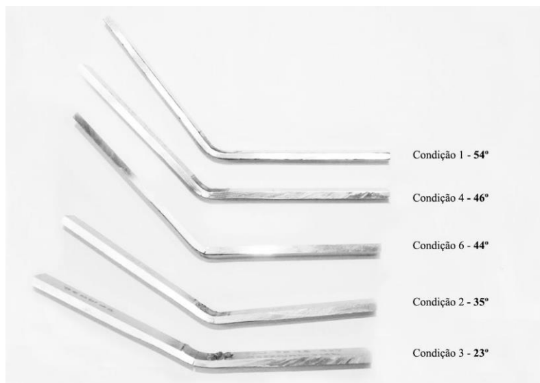
Figura 78 - Amostras do material AISI 316L submetidas ao ensaio de dobramento.
