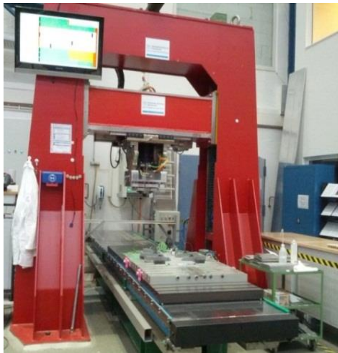
Figura 22 - Equipamento utilizado para a soldagem FSW com gás inerte acoplado junto à ferramenta.
