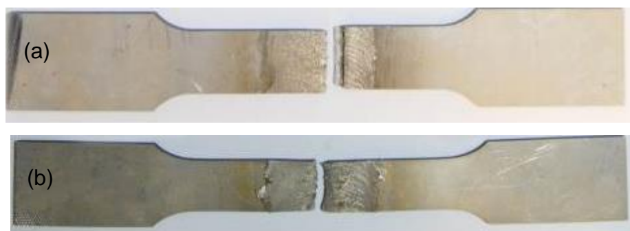
Figura 81 - Corpos de prova após o ensaio de tração uniaxial (a) Condição 1 (b) Condição 4
