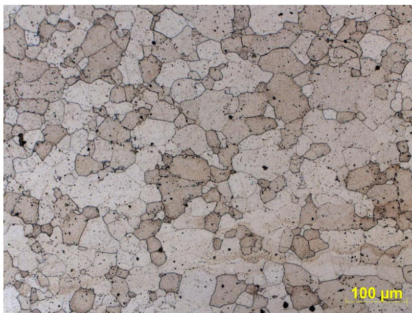
Figura 17 - Microestrutura típica do aço inoxidável ferrítico AISI 410S. Tamanho de grão ASTM 7 (Aumento 100x).
