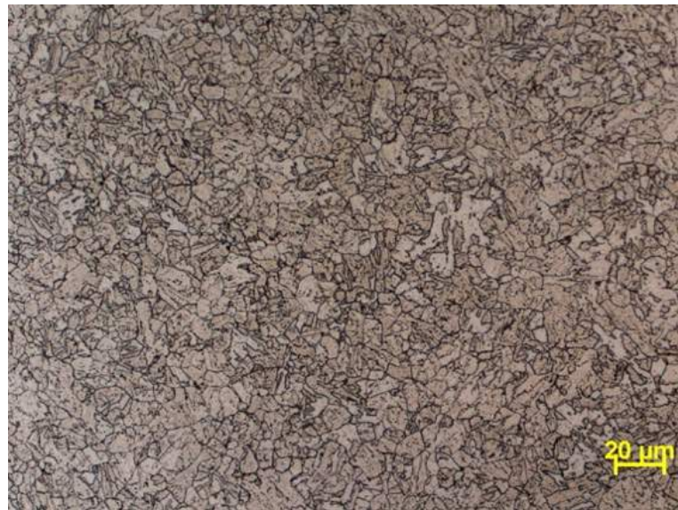
Figura 38 - Caracterização no metal de base de 2,25Cr-1Mo-0,25V. Ataque Nital 2%
