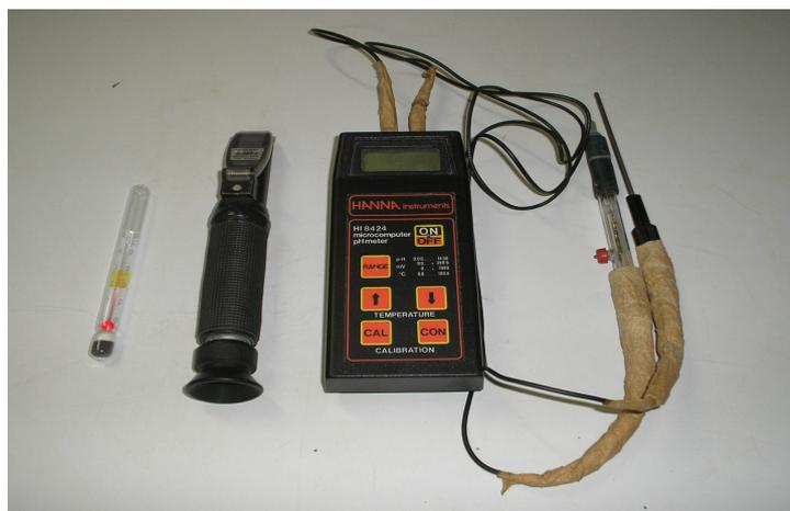
Figura 21. Instrumentos eletrônicos utilizados na medição dos parâmetros físico-químicos da água de cultivo.
