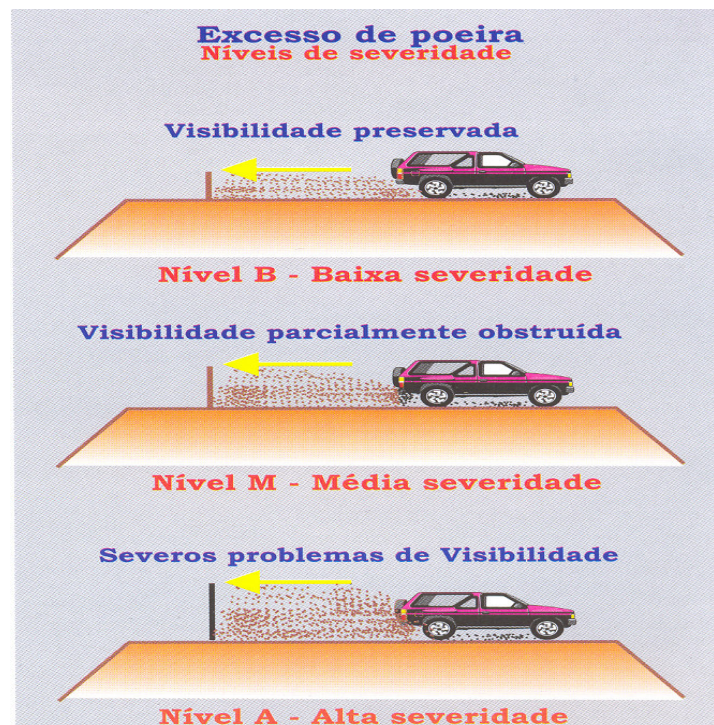
Figura 11: Níveis de Severidade do Defeito Excesso de Poeira (UNITED NATIONS ECONOMIC COMMISSION FOR AFRICA, 1982)
