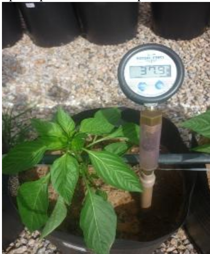
Figura 6 – Tensiômetro instalado com cápsula porosa a 20 cm de profundidade.
