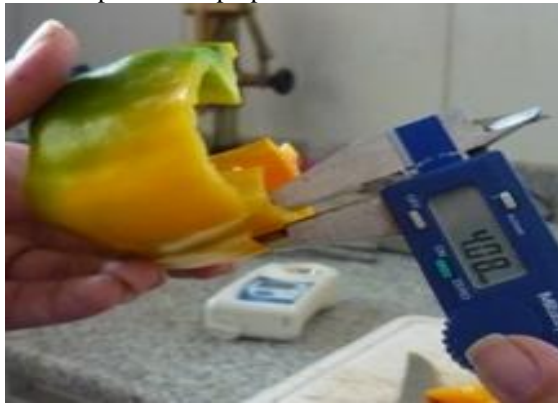
Figura 11 - Paquímetro digital para mensuração da variável espessura da polpa.
