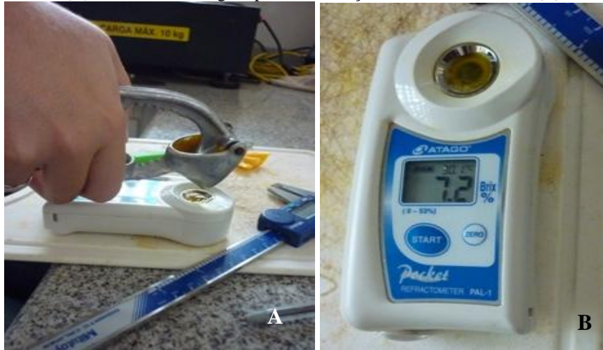
Figura 10– Extração do suco para mensuração dos sólidos solúveis do fruto de pimentão (A). Refratômetro digital para mensuração dos sólidos solúveis (B).
