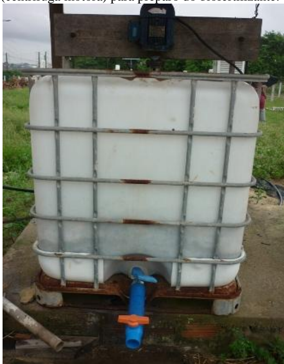
Figura 5 - Contentor com agitação mecânica (centrífuga motora) para preparo do biofertilizante.
