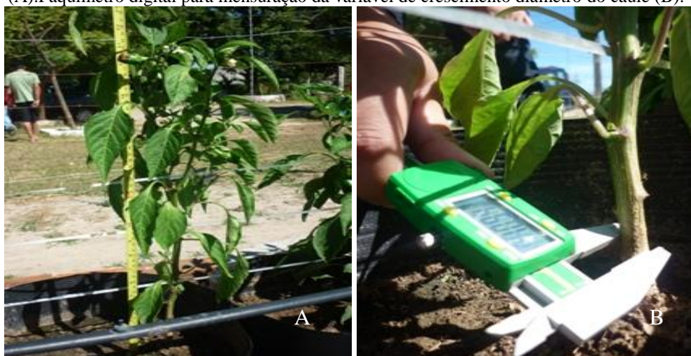
Figura 8 - Trena graduada para mensuração da variável de crescimento altura de planta (A). Paquímetro digital para mensuração da variável de crescimento diâmetro do caule (B).
