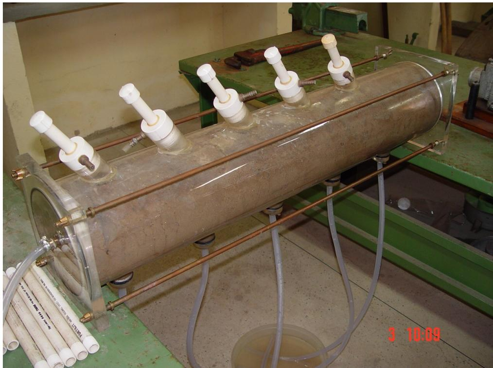
FIGURA 7 – Coluna de solo no tubo de acrílico, antes da inserção dos sensores de umidade do solo e de temperatura.
