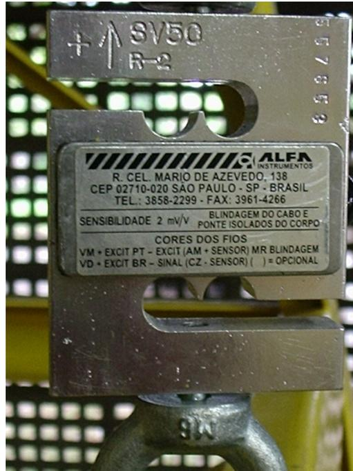
FIGURA 4 – Célula de carga utilizada no calibrador
