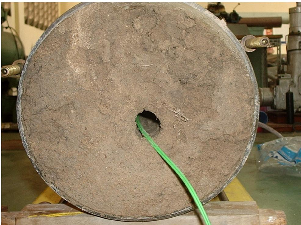
FIGURA 13 – Detalhe da inserção do sensor Watermark na coluna de solo.
