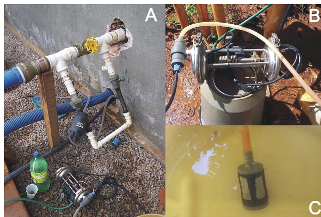
Figura 15: Sistema injetor de fertilizantes. (A) Visão geral do sistema injetor (B) Detalhe da bomba injetora (C) Detalhe do filtro na mangueira de sucção
