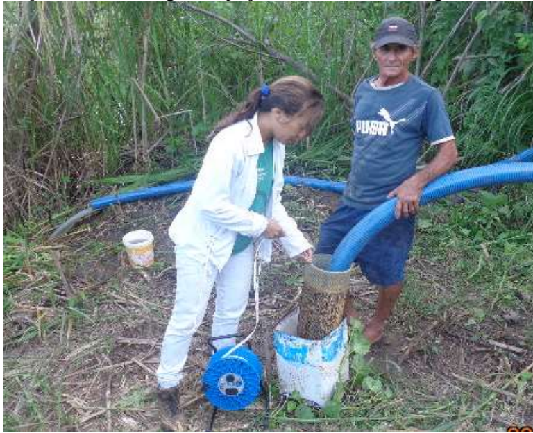
Figura 6 – Medição do nível da água no poço F5 do Perímetro Irrigado Curu Pentecoste - CE.
