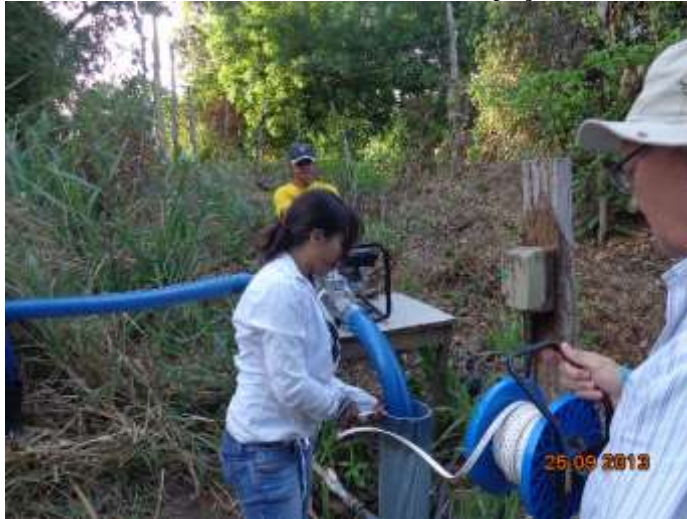
Figura 11 - Teste de Condutividade Hidráulica em um poço aluvionar no PICP.
