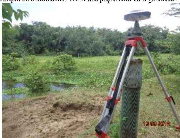
Figura 4 - Obtenção de coordenadas UTM dos poços com GPS geodésico no PICP - CE.
