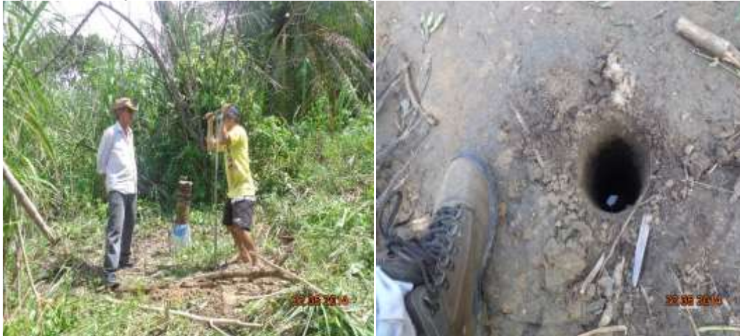
Figura 10 – Poço de observação do nível d'água.
