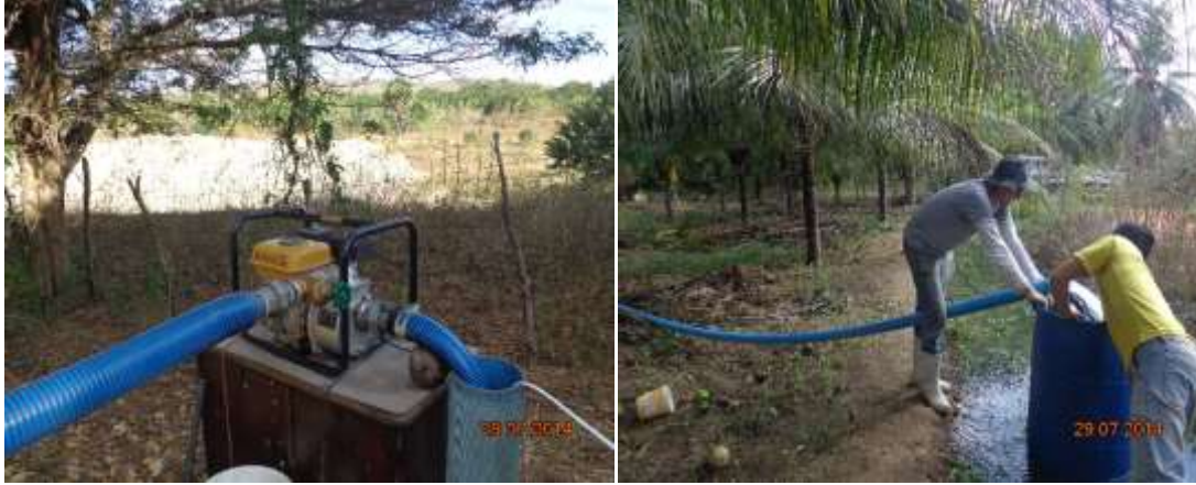
Figura 7 - Realização do teste de produção no poço raso F1, PICP -CE.
