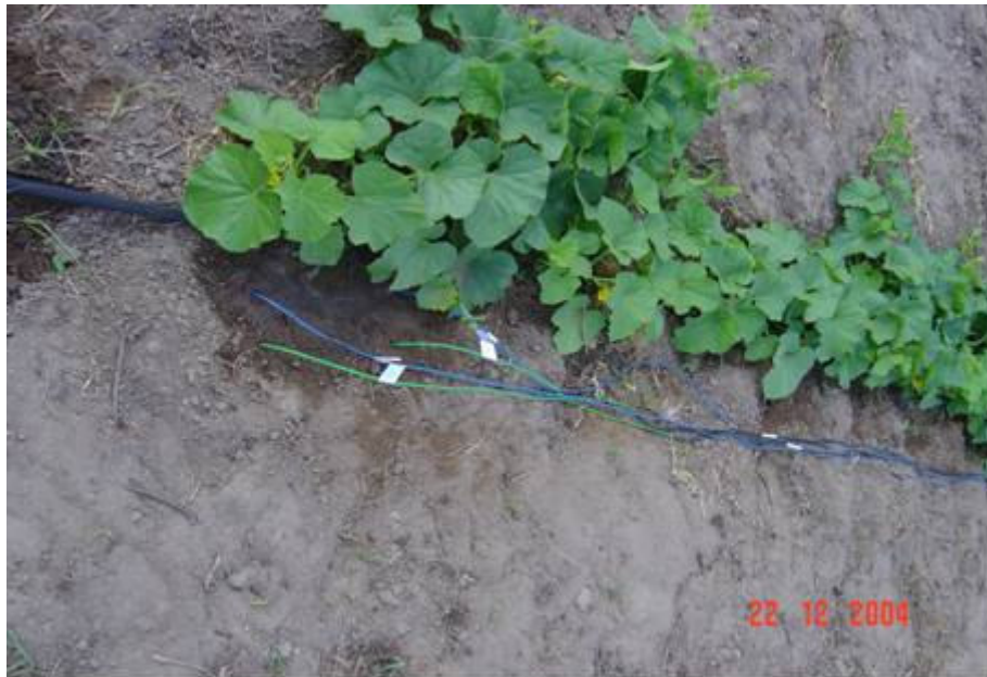
Figura 5. Sensores no campo. (30 cm e 15 cm).
