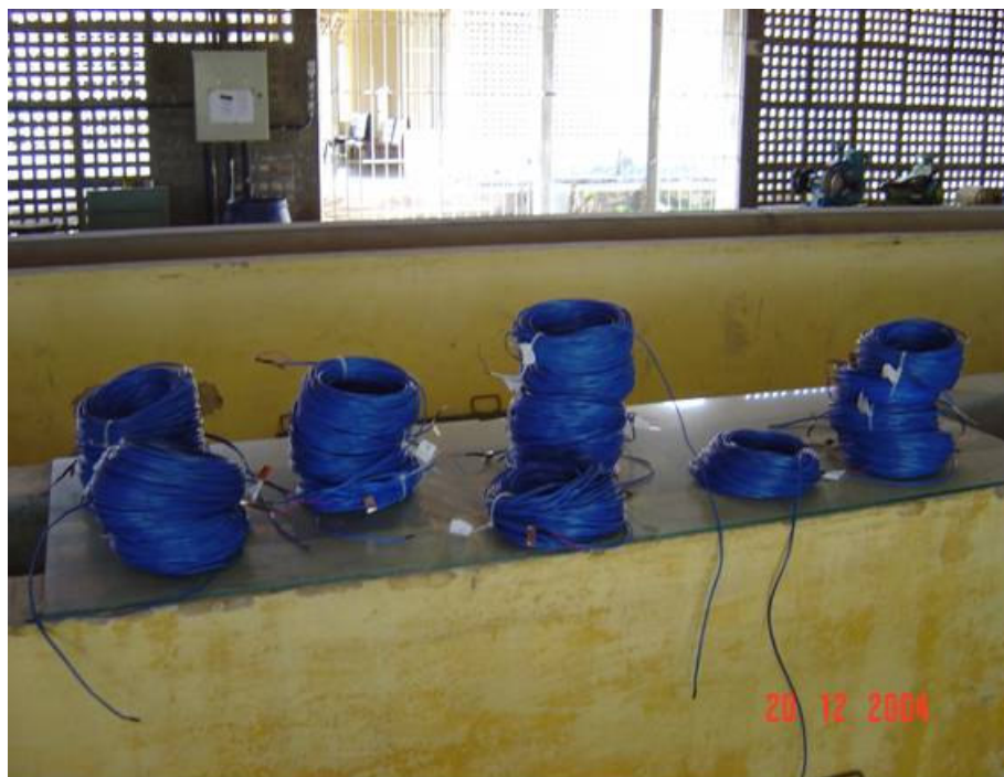
Figura 12. Sensores de temperatura prontos para serem instalados no campo.
