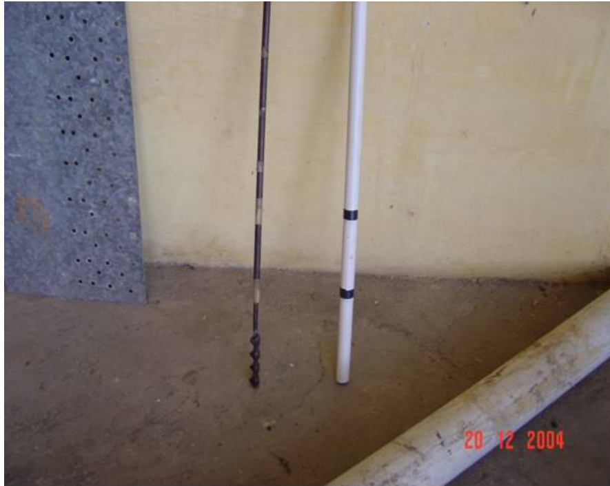
Figura 13. Instrumentos utilizados para a instalação dos sensores de umidade e temperatura do solo.
