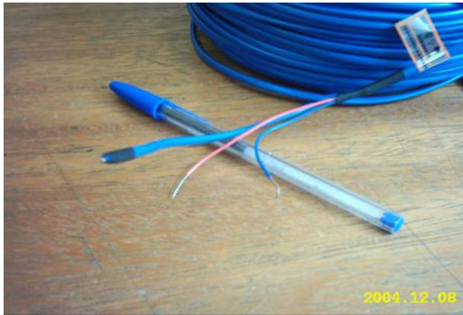
Figura 11. Termopares tipo T (cobre e constantan) utilizados no experimento.
