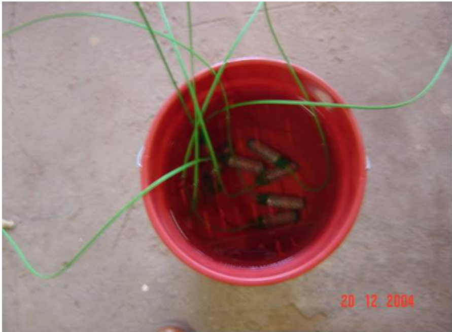
Figura 10. Visão geral dos sensores de umidade em saturação.
