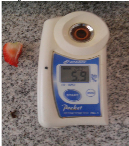
Figura 7 – Refratômetro digital utilizado para medição de sólidos solúveis dos frutos do morangueiro
