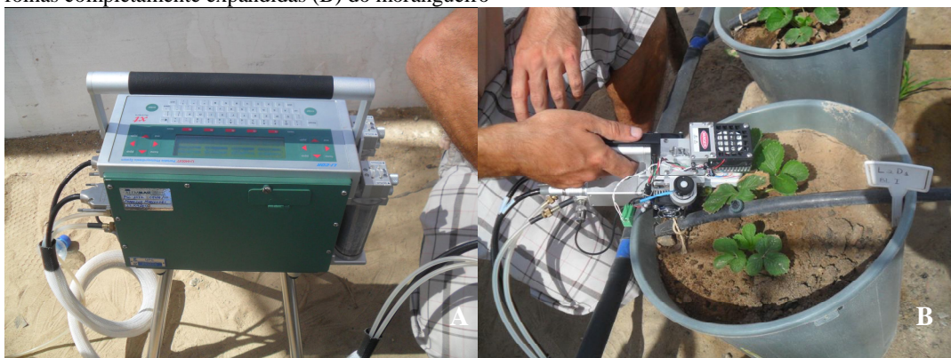
Figura 5 – Leituras das trocas gasosas utilizando o analisador de gases infravermelhos portátil (IRGA) (A) em folhas completamente expandidas (B) do morangueiro
