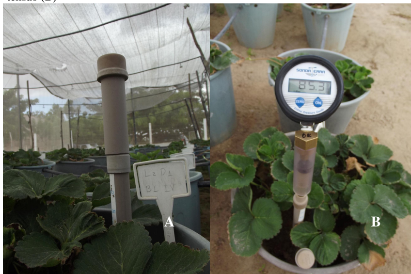
Figura 3 – Tensiômetros instalados nos vasos com morangueiro (A); leitura da tensão (B)
