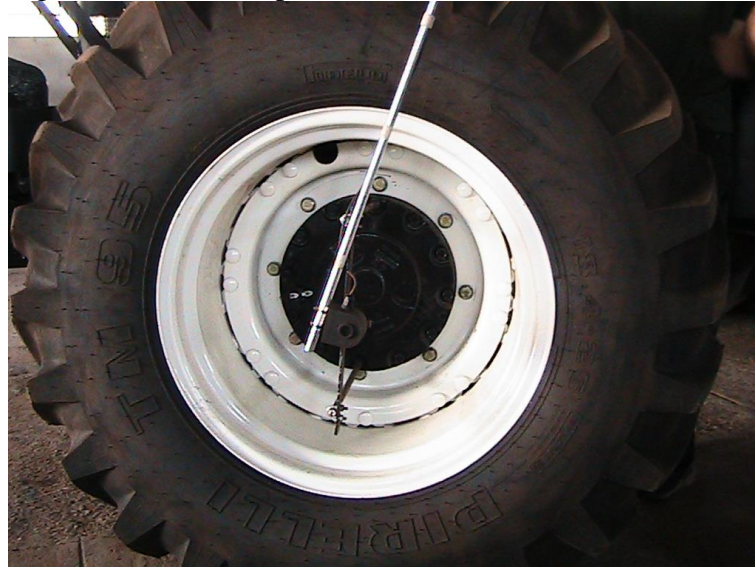
Figura 8 - Sensor de pulso instalado nos rodados do trator.
