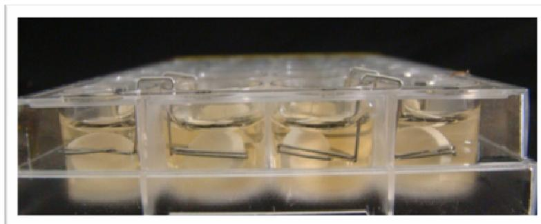
Figura 7- Discos HA em placa de poliestireno de 24 poços contendo 2 mL de meio TYB com 1% de sacarose.
