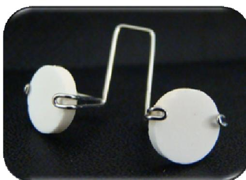
Figura 6- Dispositivo metálico desenvolvido a fim de manter os discos de HA na posição vertical.
