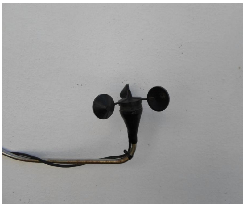
Figura 17 - Anemômetro de conchas utilizado no experimento
