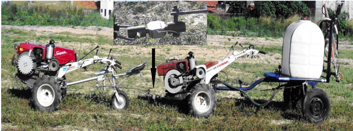
Figura 16 - Montagem da célula de carga no microtrator
