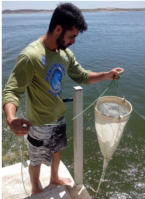
Fig. 8. Rede de plâncton de 20 \mu m de abertura de malha.
