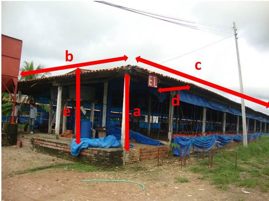
Figura 4 – Galpão avaliado no experimento - G2. As letras de “a” até “e” representam respectivamente: altura do pé-direito, largura, comprimento, beiral e cumeeira.
