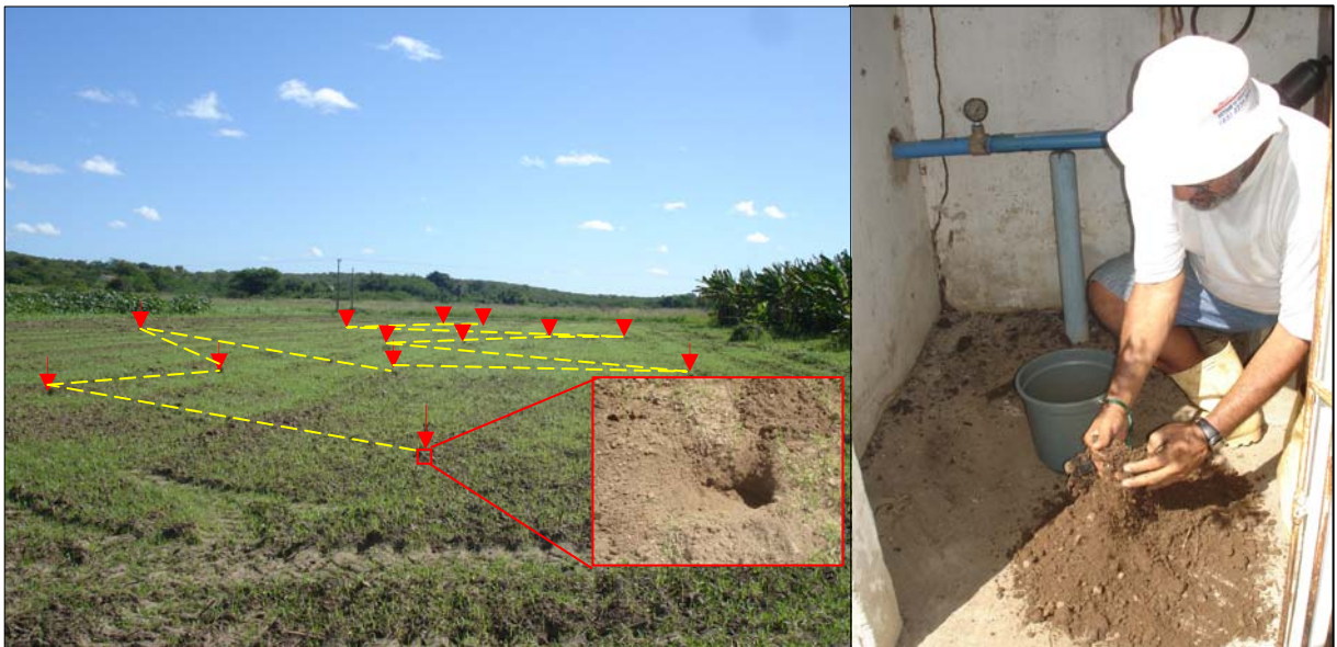
Figura 2 - Amostra composta do solo, da área experimental, para caracterização química. FEVC, Pentecoste, CE, 2007.
