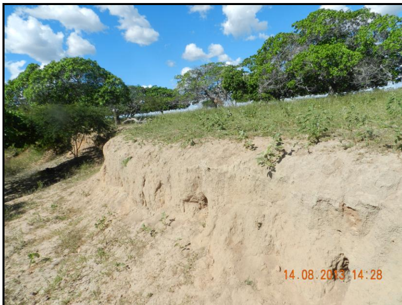
Figura 26: Perfil representativo do Argissolo Vermelho-Amarelo Distrófico, próximo ao distrito de Roldão em Morada Nova.
