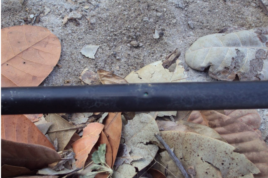
Figura 8 - Detalhe do gotejador integrado na linha lateral de irrigação, Cruz, Ceará, 2010.
