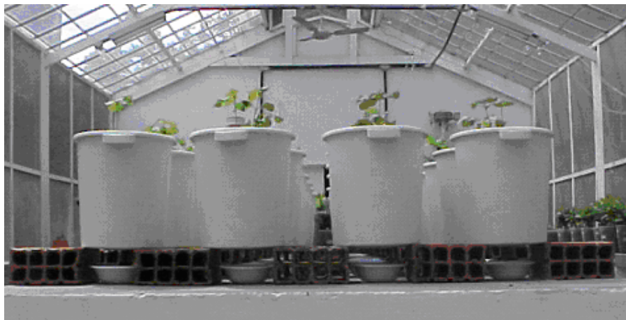
FIGURA 2 – Vista dos recipientes para as coletas de água drenada
