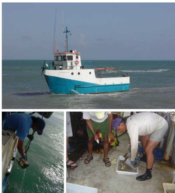
Figura 2.2 – BPq. Prof. Martins Filho (UFC) (acima), draga Van Veen em operação (abaixo à esquerda) e procedimento inicial de aquisição da amostra (abaixo à direita), na campanha oceanográfica de julho de 2010.
