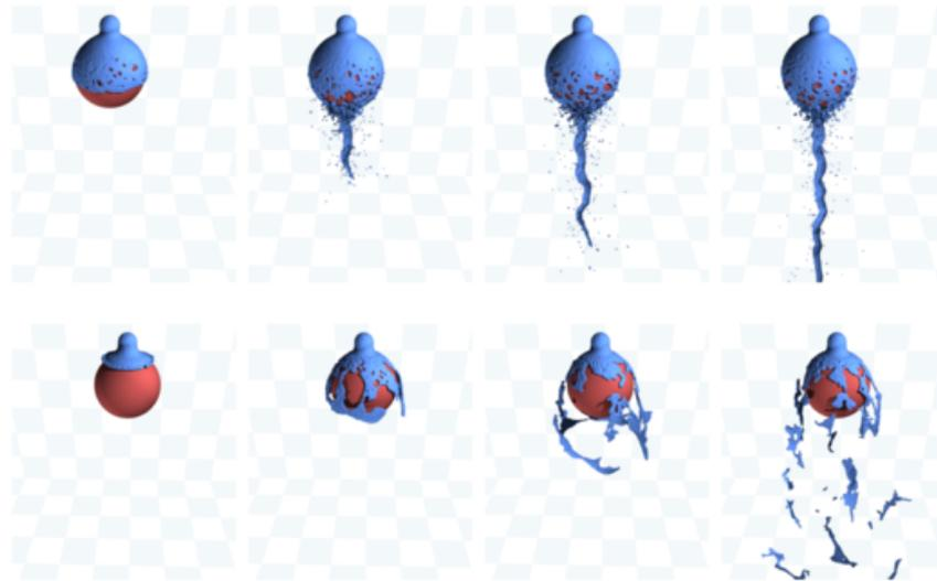
Figura 3.7: Comparação dos resultados obtidos com o método SPH com partículas fantasmas (linha superior) com aqueles obtidos com o WCSPH (linha inferior). Fonte: [Schechter e Bridson 2012].
