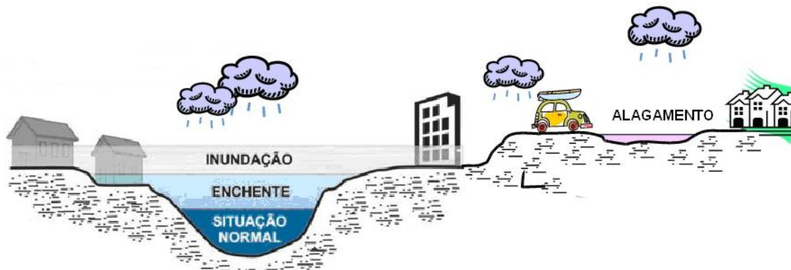
Figura 17 - Desenho esquemático que representa a diferença entre inundação, enchente e alagamento
