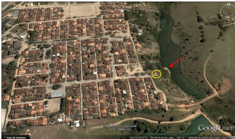
Figura 09 – Área de tabuleiro afetada por voçorocamento (círculo) no município de Eunápolis, bairro Urbis I, e assoreamento do canal do rio (seta).
