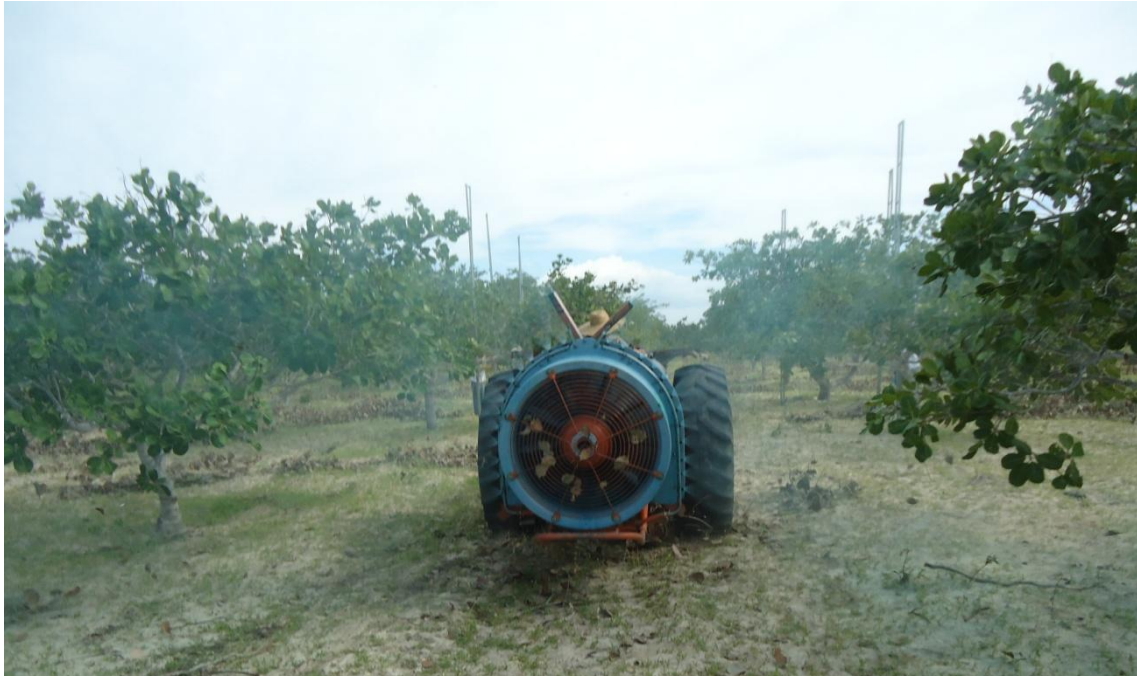
Figura 7: Conjunto de pulverização tratorizado e o turboatomizador no momento de aplicação do produto.
