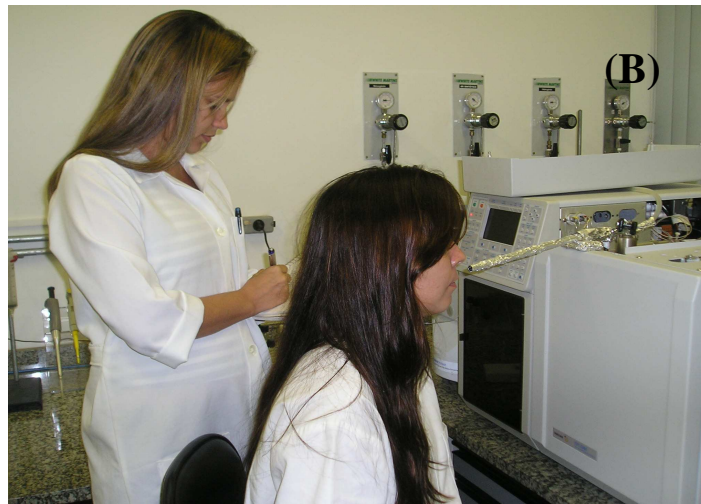
Figura 8 - Análise olfatométrica através da técnica de Osme. (A) Detalhes do julgador utilizando o mouse do computador para registrar a intensidade do aroma percebido e (B) detalhe do pesquisador anotando a descrição da qualidade do aroma.
