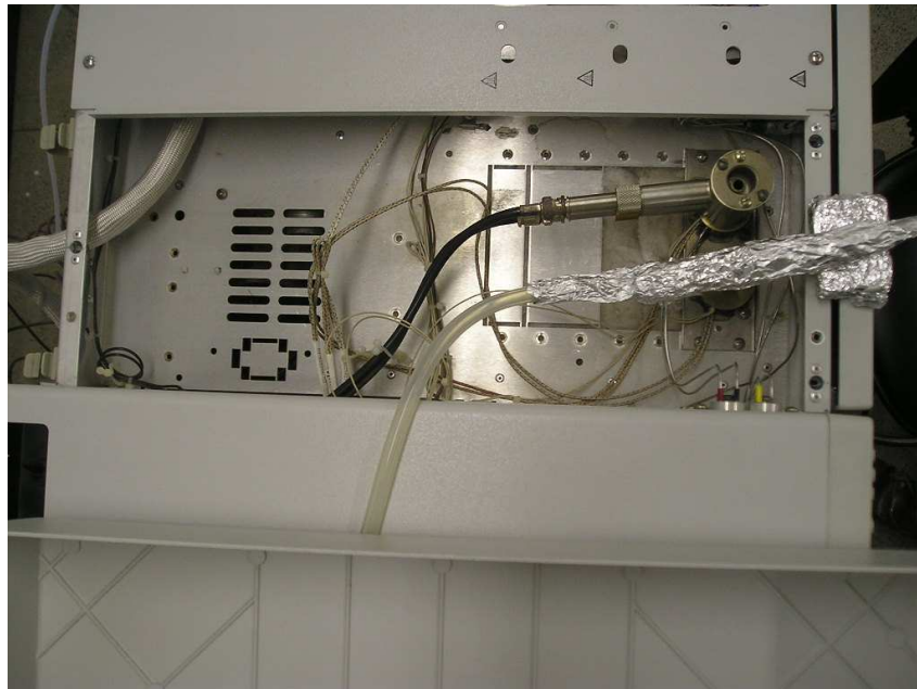
Figura 6 - Revestimento externo de fibra de vidro e papel alumínio para manter o aquecimento e evitar a condensação dos voláteis no tubo de vidro.
