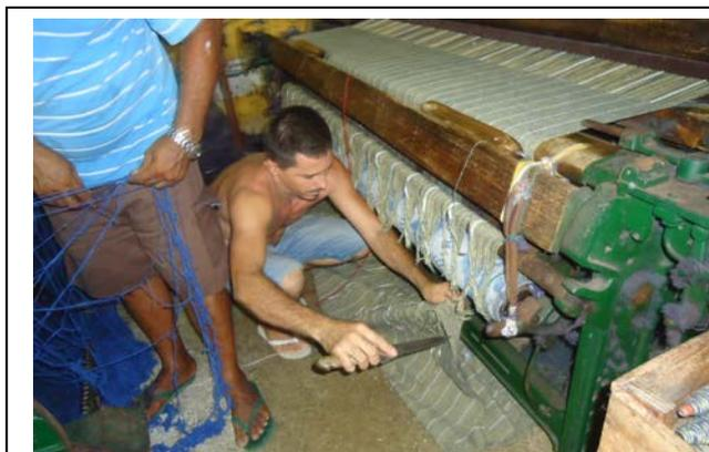
Foto 55: Corte manual inadequado e inexistência de uso de EPI(Equipamentos de Proteção Individual)
