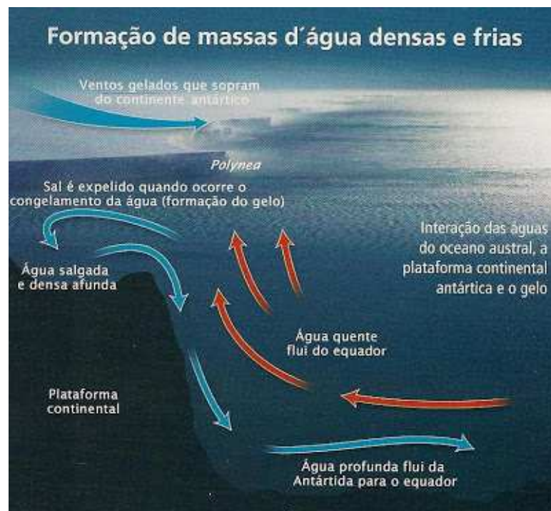
Figura 3- Transporte de massas d'água densas frias e ricas em \text{CO}_2 dos polos para o Equador.
