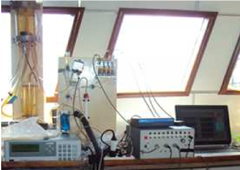
Figura 13-Fotografia do sistema francês (IRD LOCEAN) de medição contínua de CO 2 a bordo do Corenav III em outubro de 2012.
