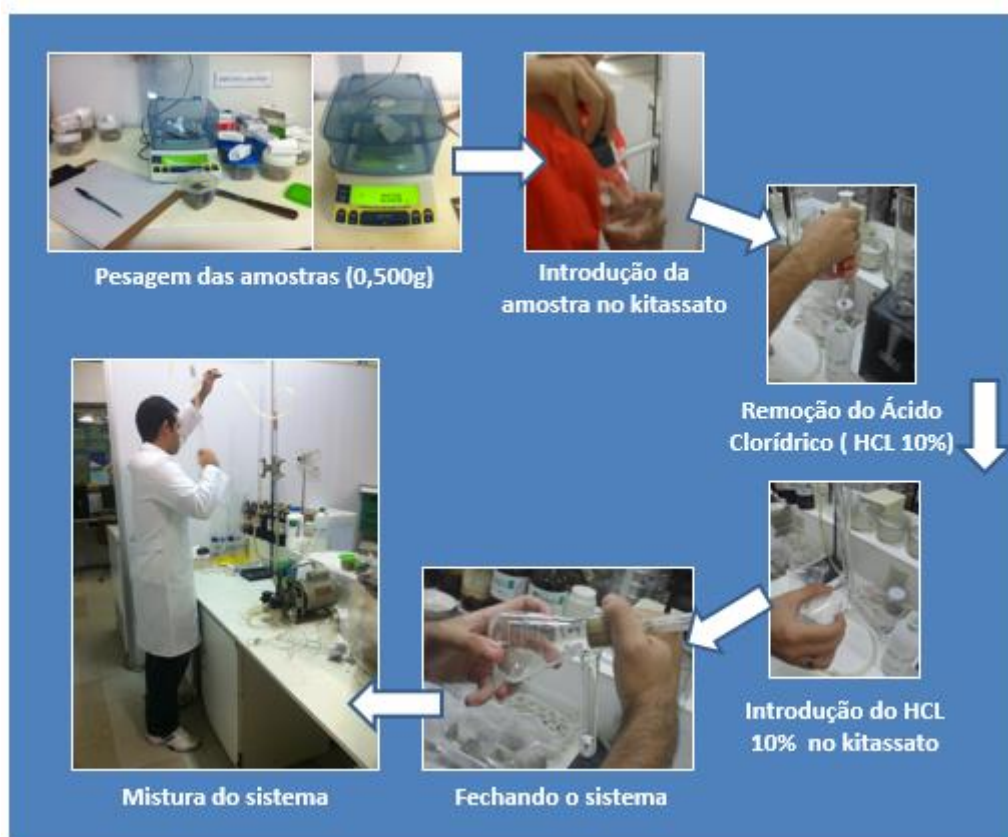
Figura 23: Etapas do processo de medição do teor de carbonato de cálcio utilizando o Calcímetro de Bernard (modificado).
