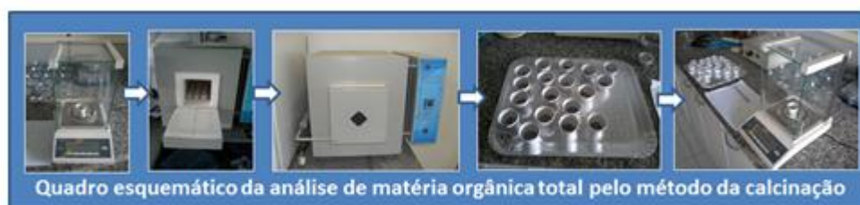
Figura 24: Processo de medição do teor de matéria orgânica utilizando a metodologia da calcinação
