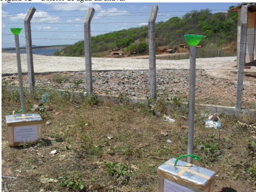
Figura 12 – Coletor de água da chuva.
