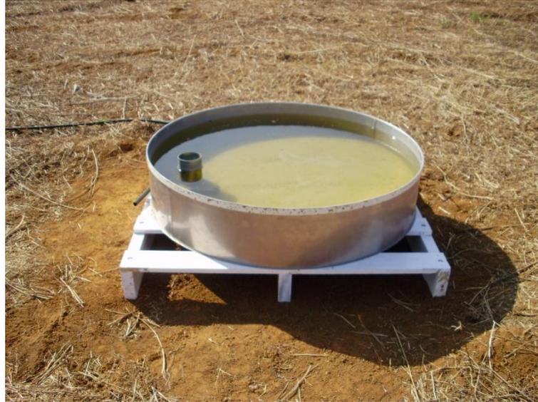
Figura 6 – Tanque Classe “A” instalado na área experimental para a quantificação da evaporação diária.
