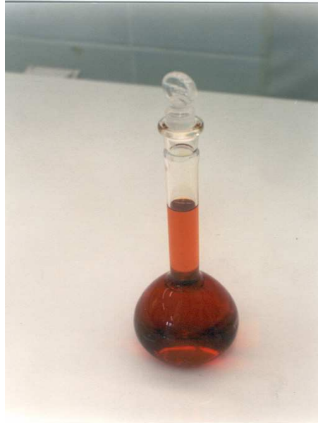
Figura 8 - Extrato pigmentado resultante da filtração e posterior concentração
