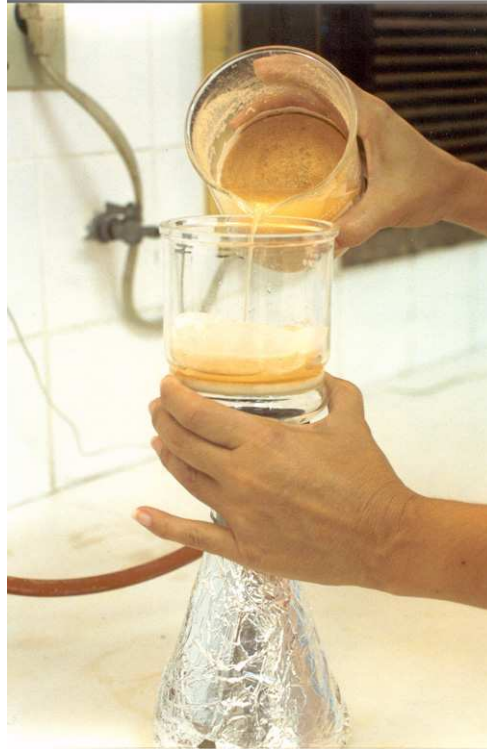
Figura 7 - Filtração do extrato pigmentado através de funil de Buchner em frasco de Kitassato
