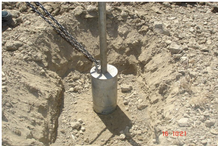
Figura 2 - Coleta de amostras de solo para teste de K_0 .
