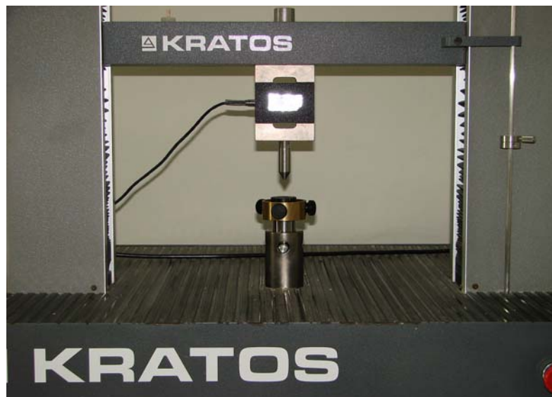
Figura 2 - Base metálica para inserção da amostra
