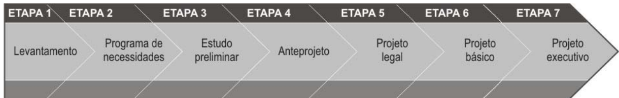
Figura 2.4. Etapas do processo de projeto na construção civil
