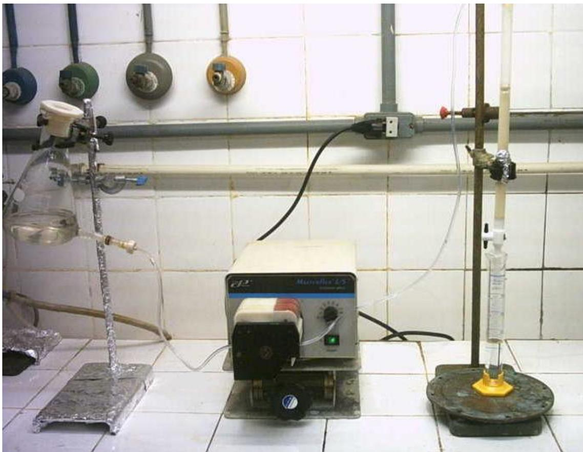
FIGURA - 6: Imagem da instalação experimental da coluna de adsorção.
