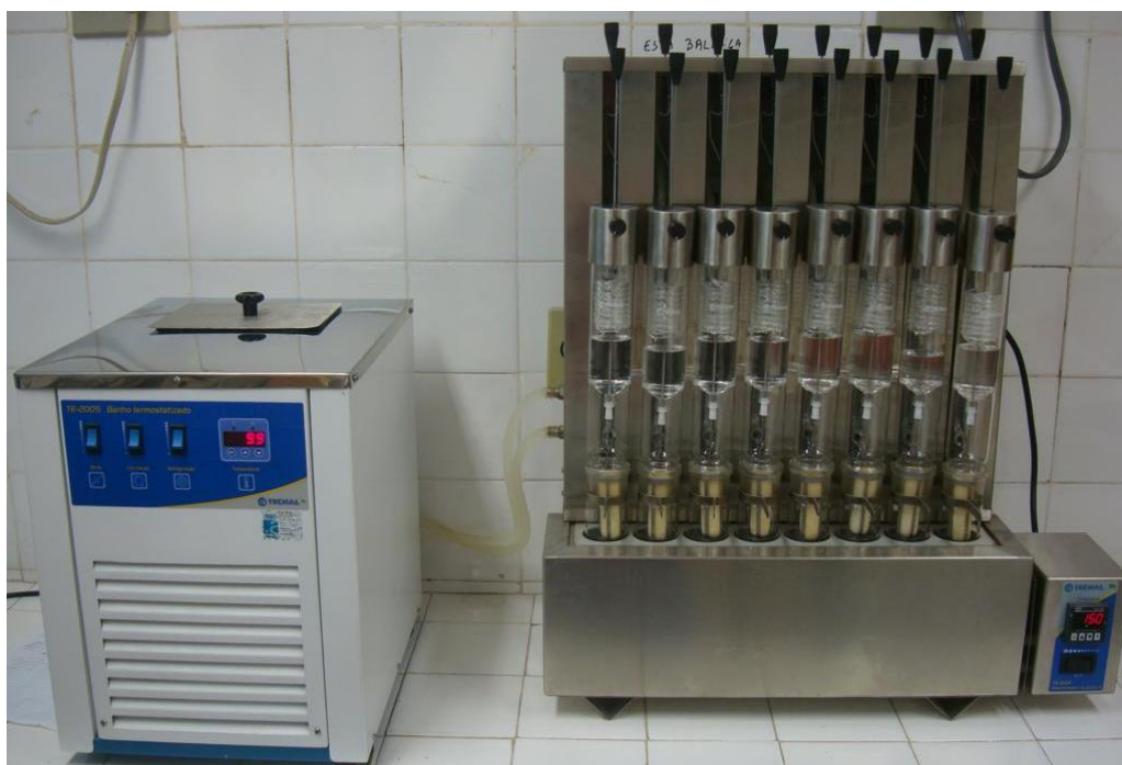
Figura 4 - Aparelho extrator de gordura modelo TE - 044 da TECNAL ® utilizado para a determinação do teor de óleo dos aquênios. Pentecoste – CE, 2010.
