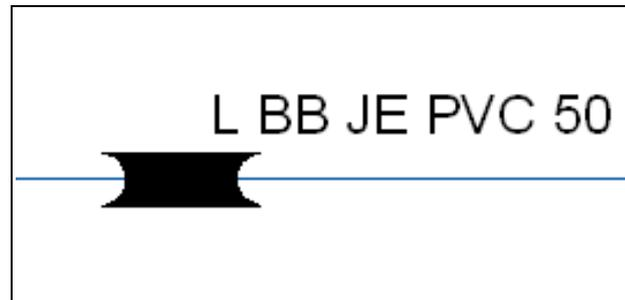
Figura 3. 14 – Representação de conexão: Redução.
